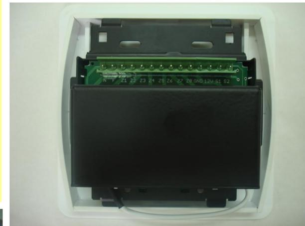
Na parte traseira do sistema, temos todas as conexões necessárias para a sua ligação. Com concepção integrada, a sua instalação é extremamente simples, necessitando apenas dos condutores de Fase e Neutro e dos retornos das lâmpadas.
